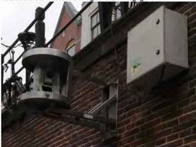
Figuur 3.2: Voorbeeldfoto Robotic Totalstation Leica TM-30
