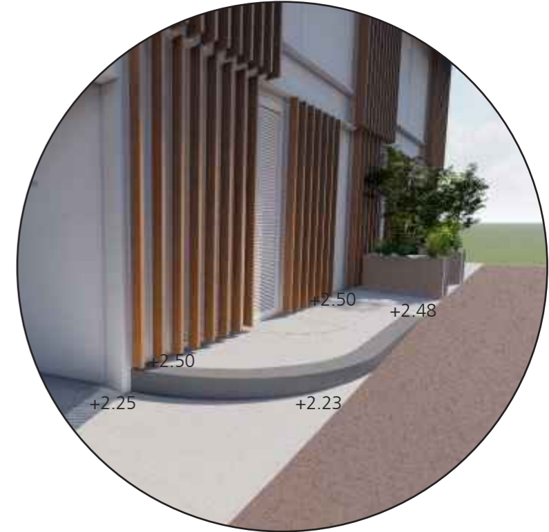
hoogteverschil bij inrit parkeergarage oplost door ronde band
