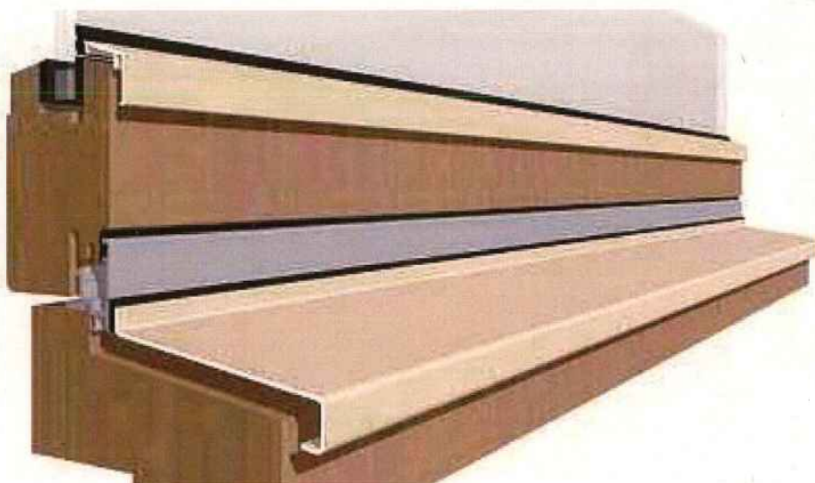
Waterslag uit gezette plaat
