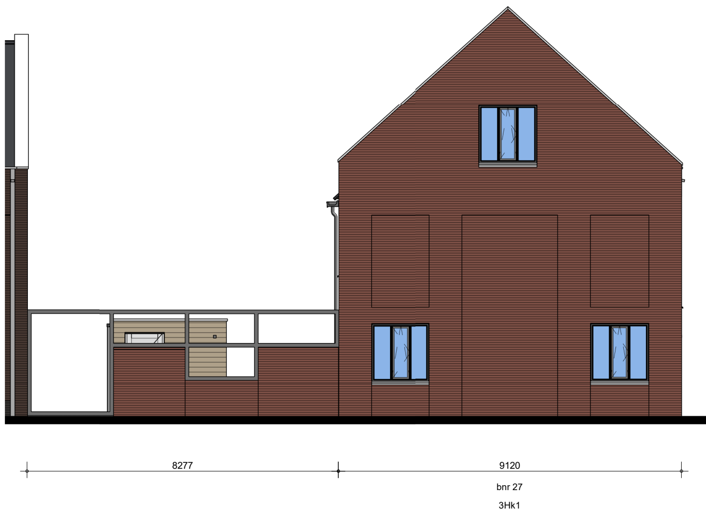
Zonwerend glas bij elk kozijn in kopgevel Blok 4
