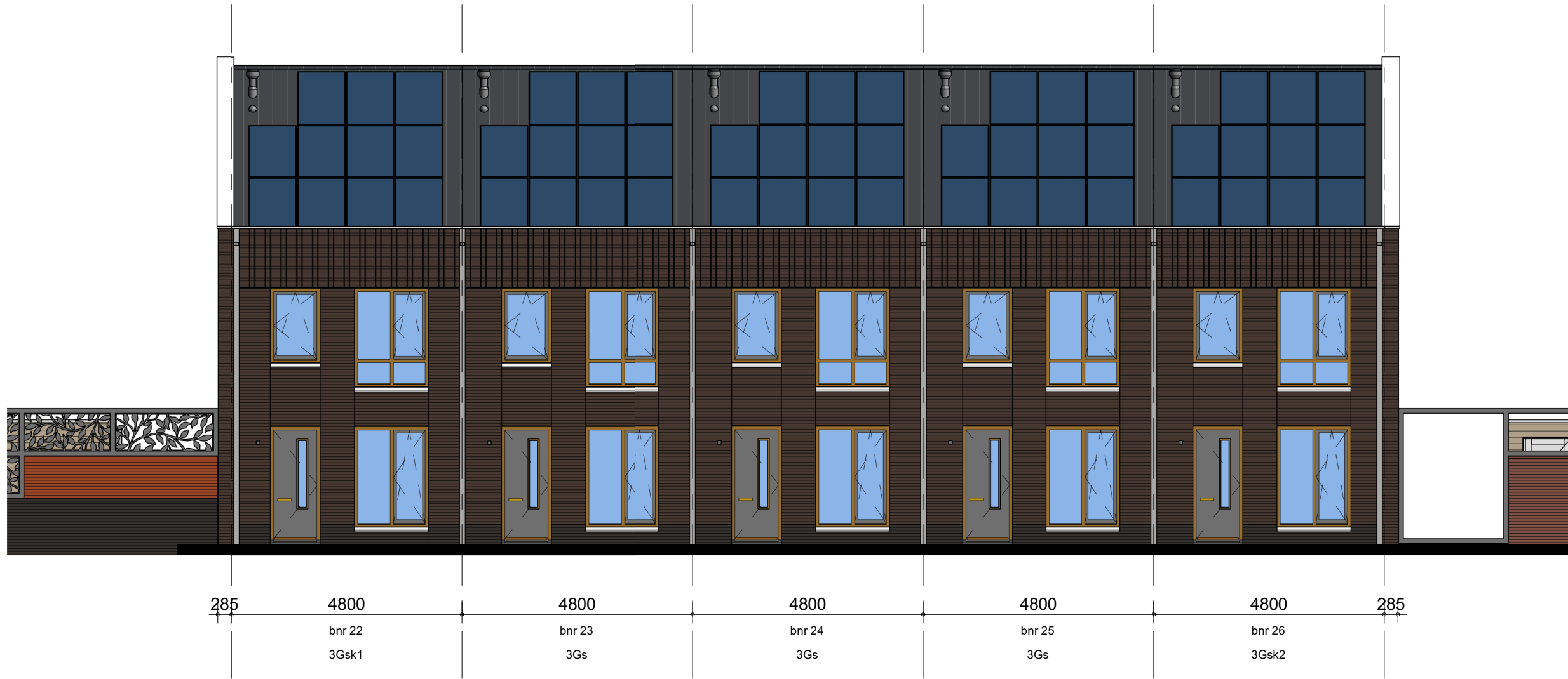
Zonwerend glas aanbrengen in elk kozijn in voorgevel Blok 3
