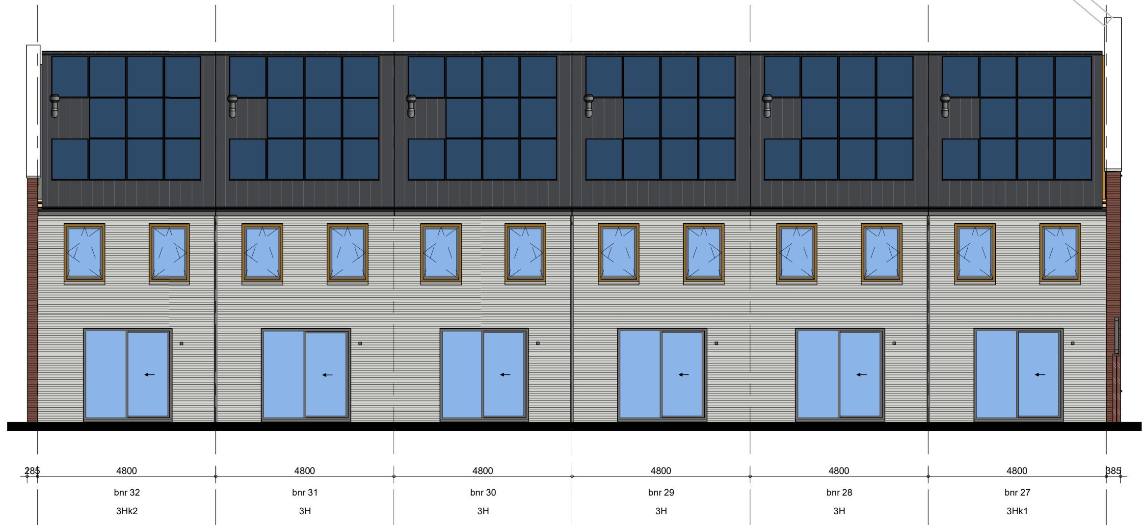
Zonwerend glas aanbrengen in elk kozijn in achtergevel Blok 4
